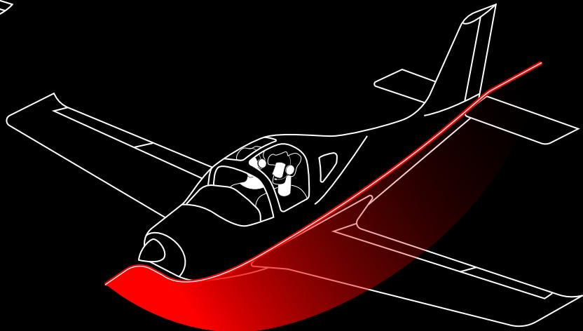
Y ahora lo esencial: la potencia adicional necesaria incluso para un pequeño incremento de velocidad se vuelve dramáticamente más costosa con resistencia más alta. La potencia necesaria para superar la resistencia aumenta al cubo de la velocidad de vuelo. Al mismo tiempo, la resistencia de forma depende directamente del área frontal, y esta crece, como ya se ha visto, al cuadrado
