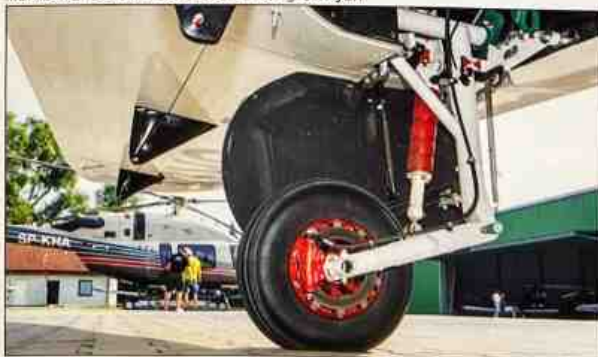
Amortyzowane zawieszenie przedniego koła zapewnia bezpieczeństwo kołowania po gruntowych nawierzchniach
