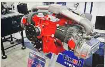
Silnik Swiatek V-X 100i o mocy 93 KM przy 3100 obr/min - wkrótce w sprzedaży
