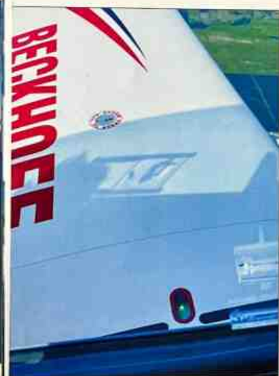
Zielona dioda sygnalizuje prawidłowe zamknięcie podwozia
