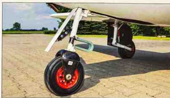
Amortyzowane zawieszenie przedniego koła zapewnia bezpieczeństwo kołowania po gruntowych nawierzchniach
