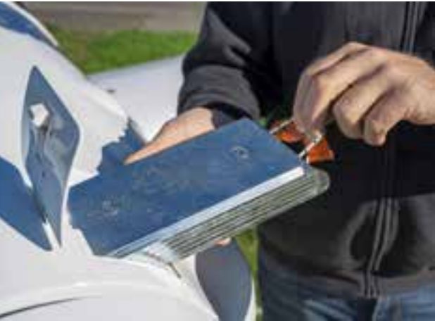
Das Avionikpaket von Dynon beinhaltet im Rahmen eines Erprobungsprogramms auch einen Autopiloten. Alternativ wird die Shark auch mit Garmin-Avionik angeboten. Oben: Das Trimmgewicht hält den Tandemsitzer in der Balance.
