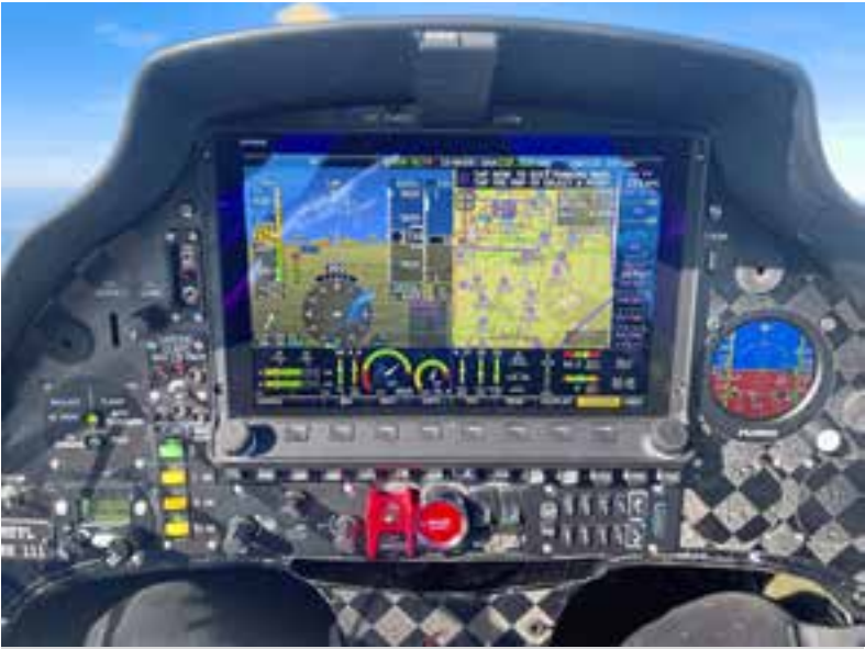
Das Avionikpaket von Dynon beinhaltet im Rahmen eines Erprobungsprogramms auch einen Autopiloten. Alternativ wird die Shark auch mit Garmin-Avionik angeboten. Oben: Das Trimmgewicht hält den Tandemsitzer in der Balance.
