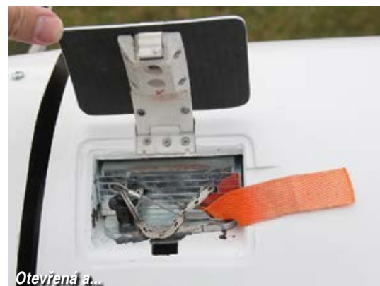
...zavřená šachta pro přední polohu závaží verze MTOM 600 kg
