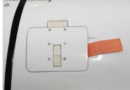
...zavřená šachta pro přední polohu závaží verze MTOM 600 kg
