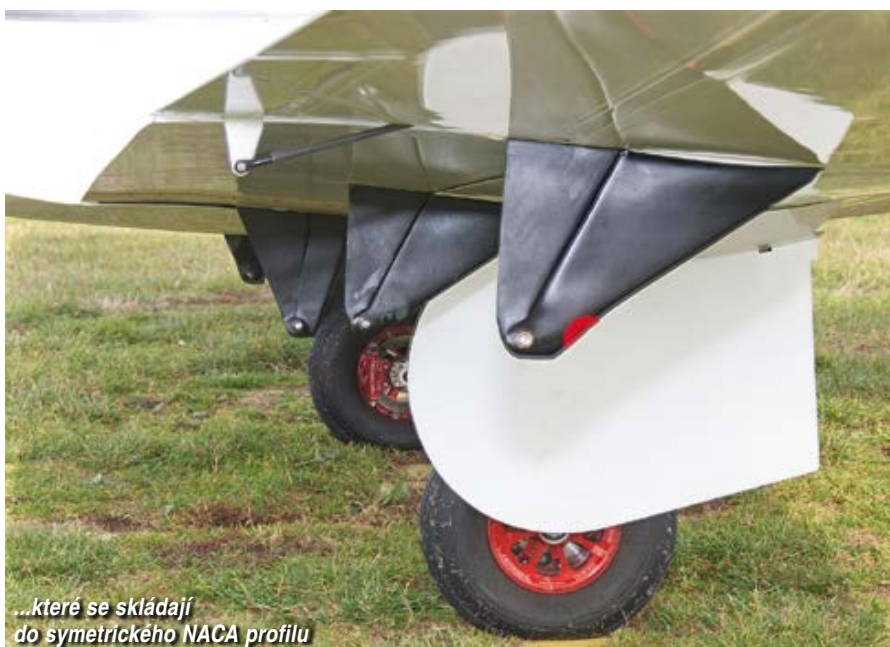
Kryty hlavního podvozku a páky zavěšení vztlakových klapek, ...
