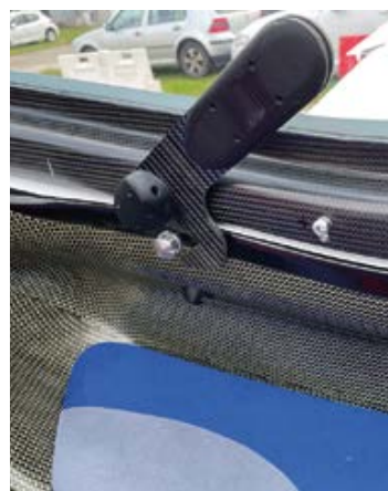
Jediný zámek zavírání kabiny umístěný za levým ramenem pilota
